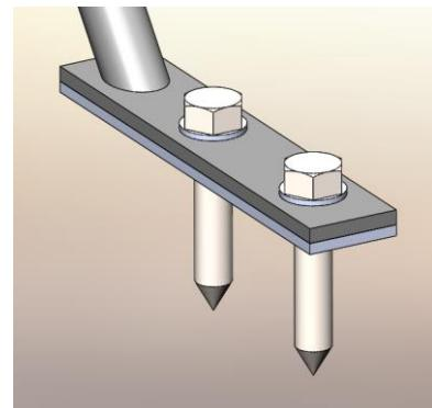
2. В отверстия кронштейнов продеваются трубы 2, и фиксируются болтами 3.
