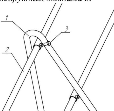
3. При соединении между собой соседних секций ограждения обжатые концы одной секции вставляются в свободные концы другой секции.
